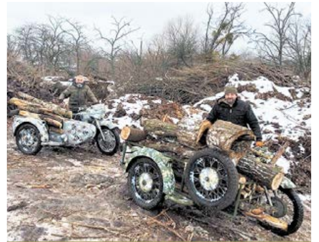
Товстенні колоди на польових випробуваннях імітують навантаження, яке на фронті випаде на залізі «спини» цих мотоциклів
